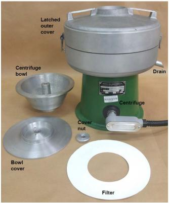
Figure 1. Centrifuge apparatus.
